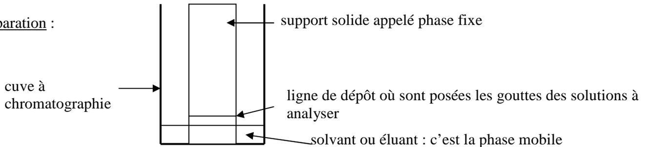
b) Elution : C'est l'étape où l'éluant monte par capillarité à la surface du support solide, en entraînant les espèces chimiques à des vitesses différentes : plus une espèce chimique est soluble dans l'éluant, plus elle est entraînée rapidement et plus elle migre haut.
